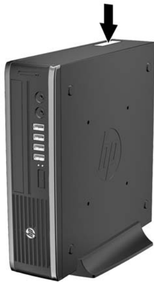
Abbildung 1-17 Position von Seriennummer und Produkt-ID des Ultra-Slim Desktop (USD)
