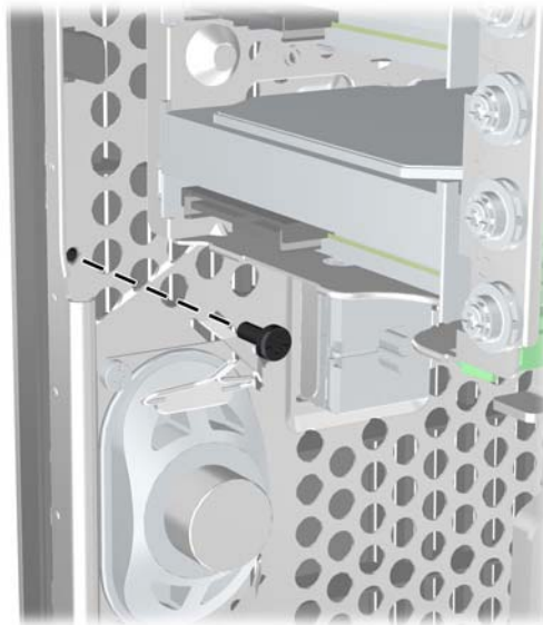
Abbildung 3-43 Installieren der Sicherheitsschraube für die Frontblende
