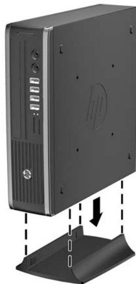
Abbildung 5-7 Platzieren des Computers auf dem Standfuß
