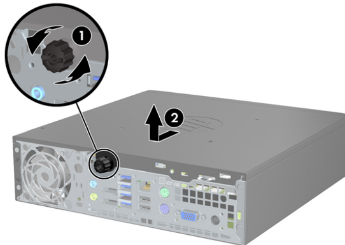
Abbildung 5-2 Entfernen der Abdeckung
