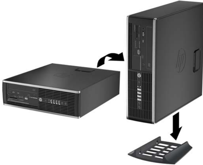
Abbildung 4-6 Umwandeln des Desktop-Systems in ein Tower-System
