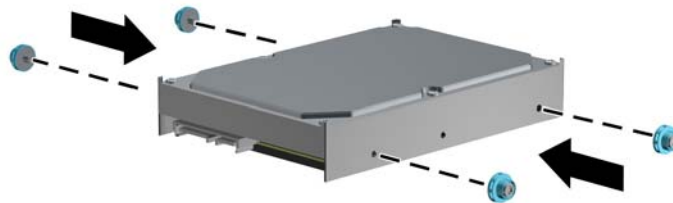
Abbildung 4-37 Anbringen der Festplattenführungsschrauben
