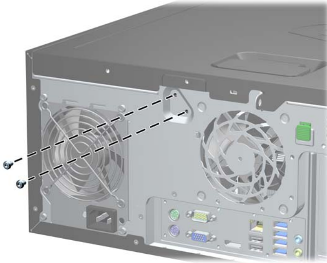
Abbildung C-2 Entfernen der Schrauben der Smart Cover-Sperre des Minitower
