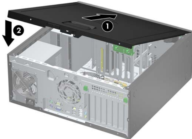
Abbildung 2-2 Anbringen der Abdeckung
