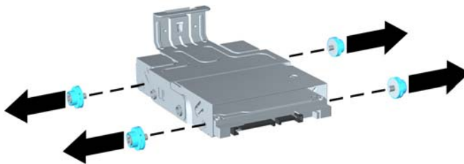
Abbildung 5-17 Entfernen der Führungsschrauben
