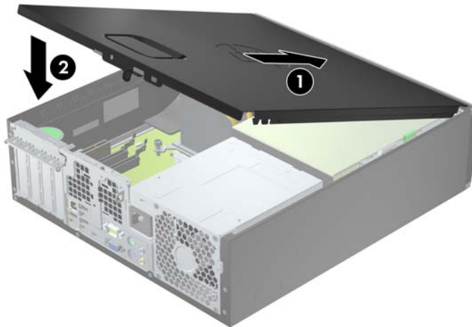
Abbildung 4-2 Anbringen der Abdeckung
