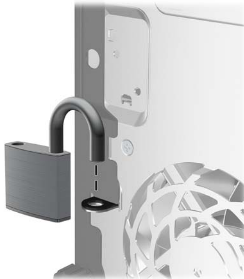
Abbildung 3-33 Anbringen eines Vorhängeschlosses
