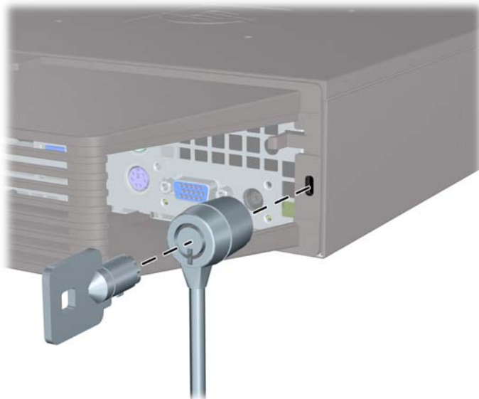
Abbildung 5-25 Anbringen einer Kabel-Diebstahlsicherung mit installierter Anschlussabdeckung
