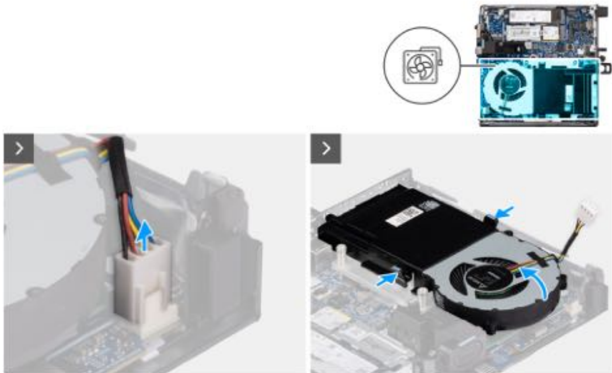
Abbildung 28. Entfernen des Lüfters
