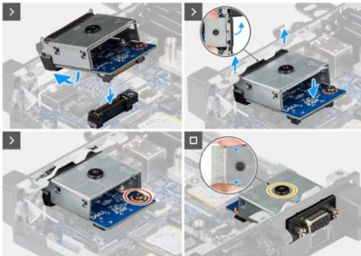
Abbildung 52. Installieren des VGA-Anschlussmoduls
