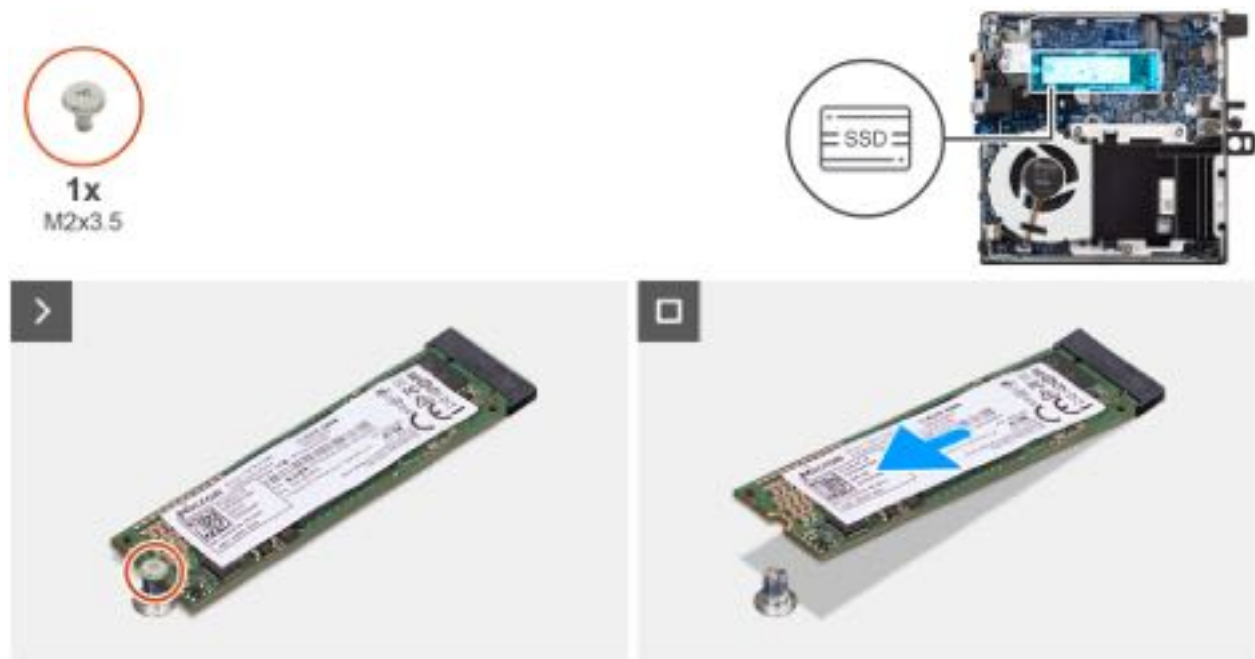
Abbildung 19. Entfernen des M.2-2280-Solid-State-Laufwerks
