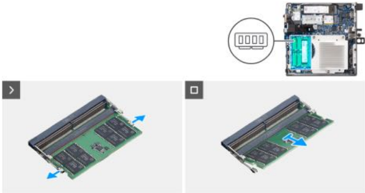
Abbildung 32. Entfernen des Arbeitsspeichers
