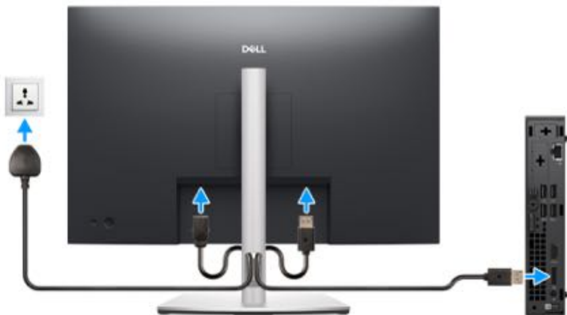
Abbildung 6. Anschließen des Bildschirms
