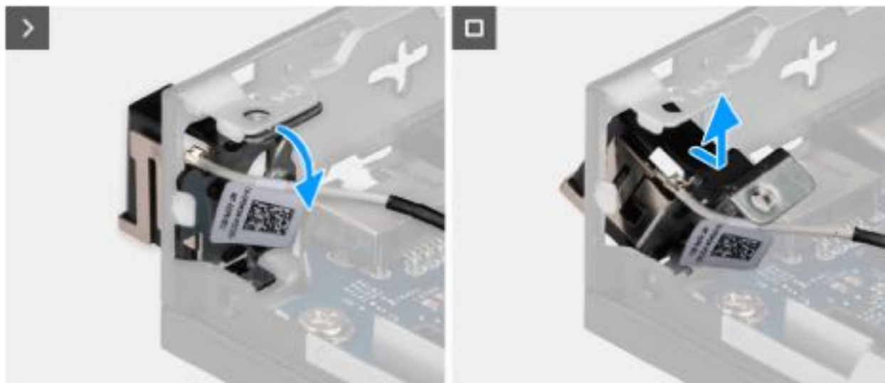
Abbildung 67. Entfernen des Antennenmoduls (weißes Kabel)
