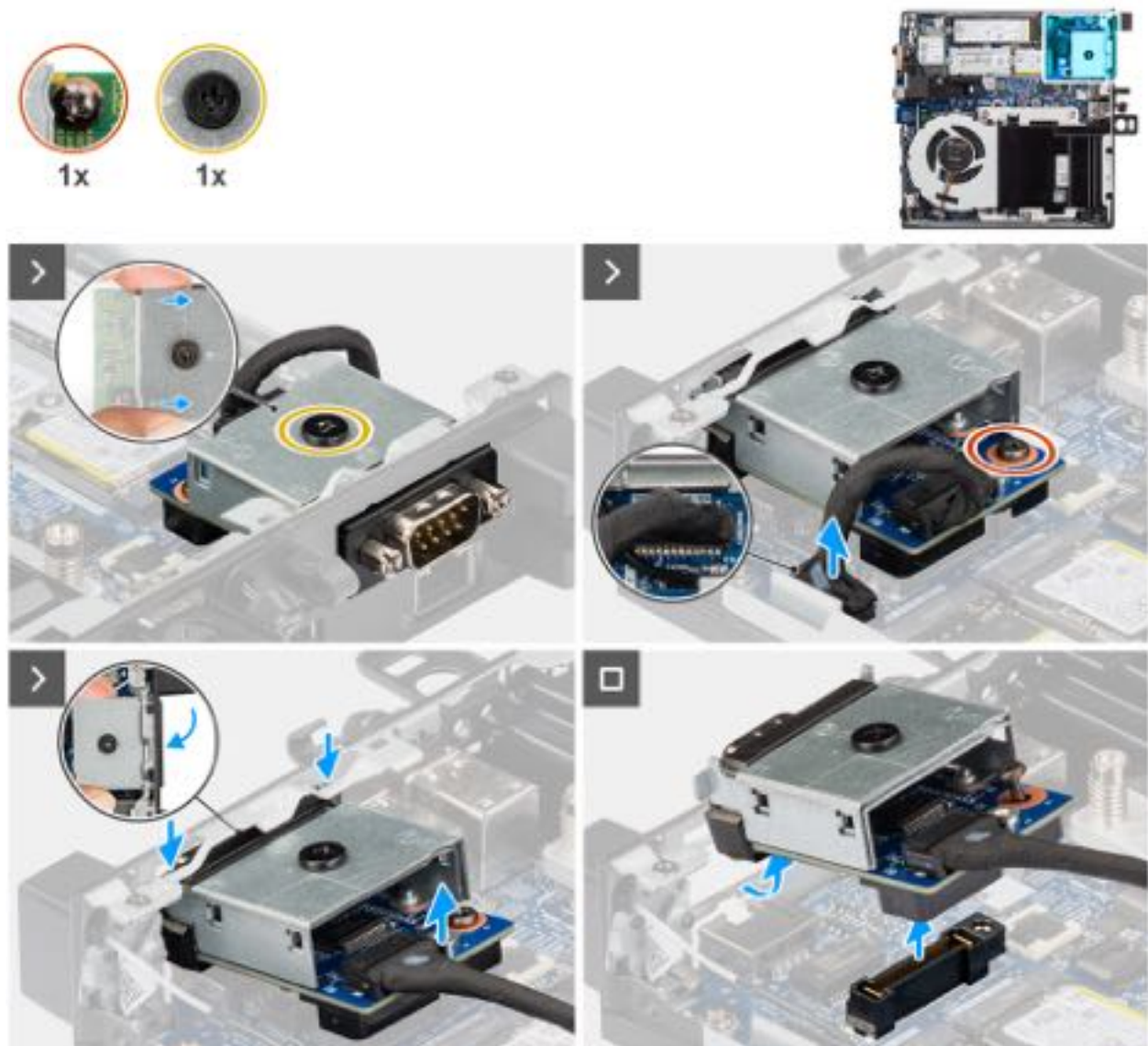
Abbildung 56. Entfernen des seriellen Anschlussmoduls
