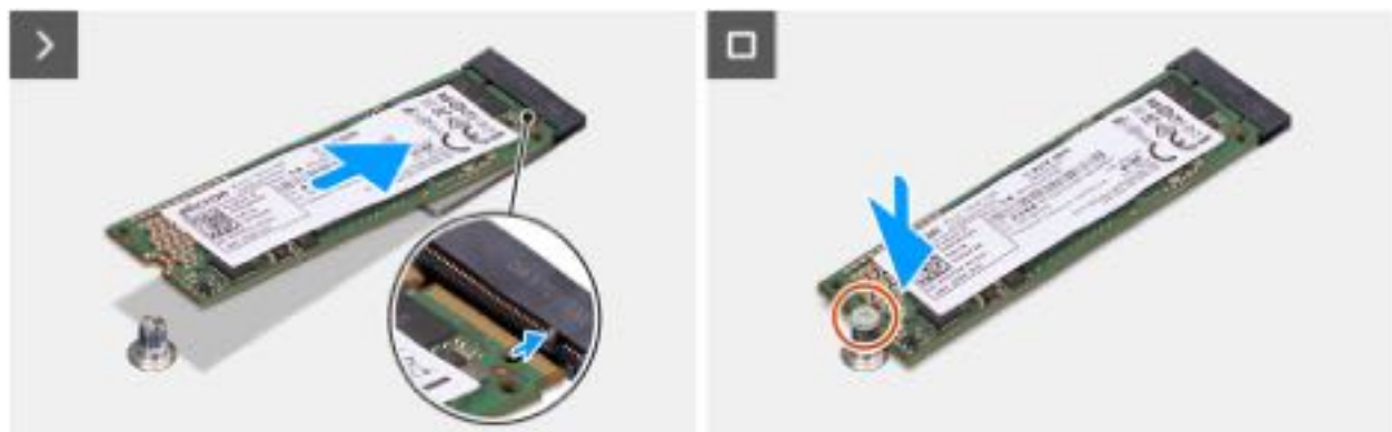
Abbildung 21. Einbauen des M.2-2280-Solid-State-Laufwerks
