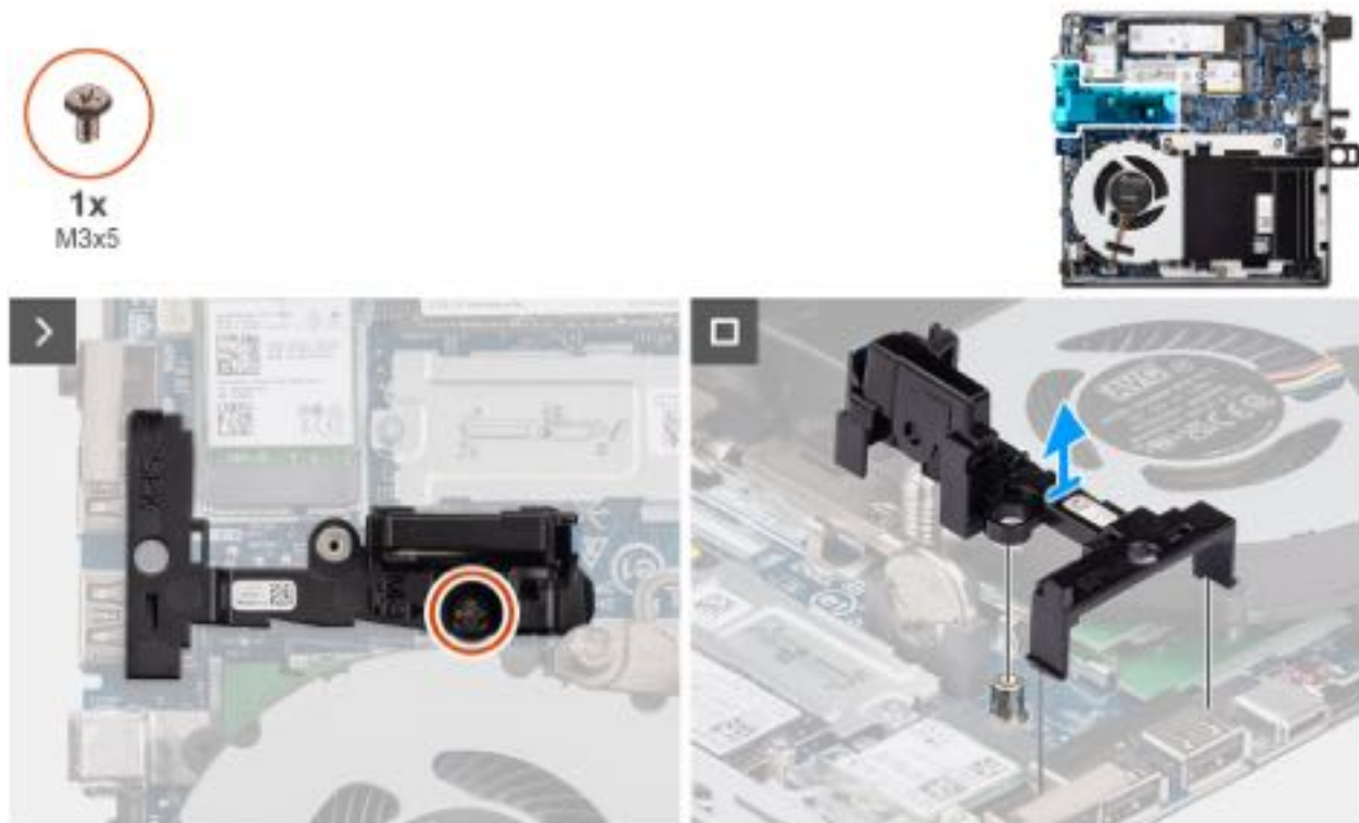
Abbildung 72. Entfernen der Lautsprecherhalterung
