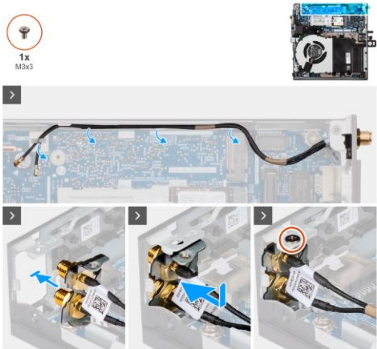
Abbildung 37. Installieren des SMA-Antennenmoduls
