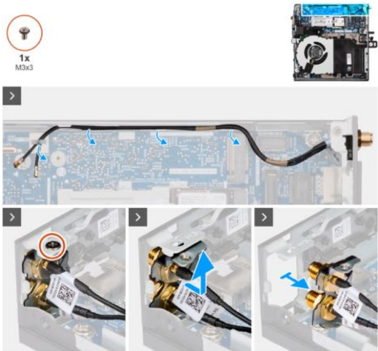
Abbildung 36. Entfernen der SMA-Antenne
