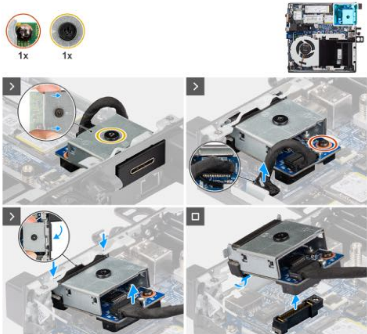
Abbildung 53. Entfernen des PS2-Anschlussmoduls
