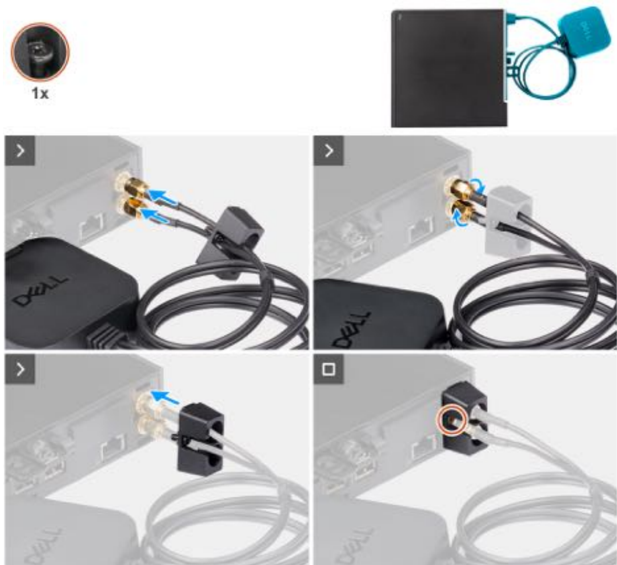
Abbildung 35. Einbauen der externen Puck-Antenne
