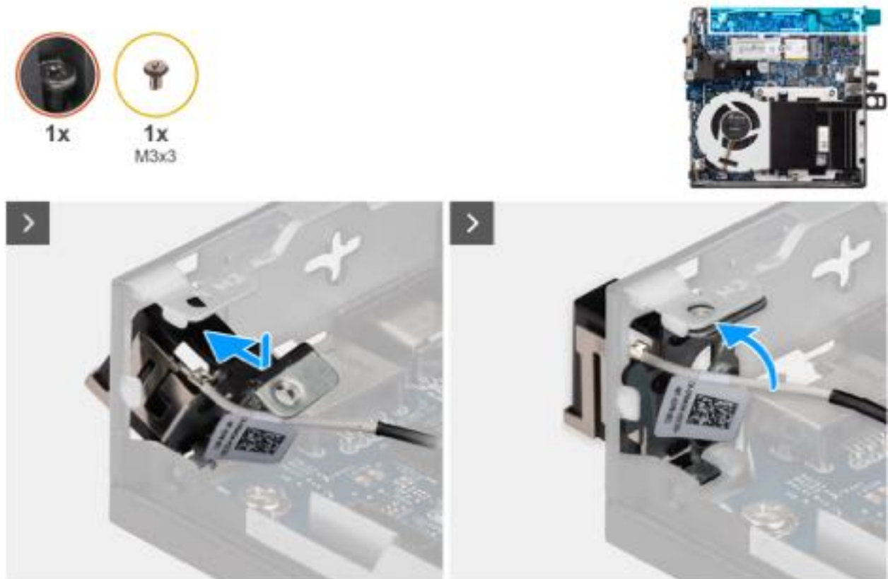
Abbildung 68. Einbauen des Antennenmoduls (weißes Kabel)
