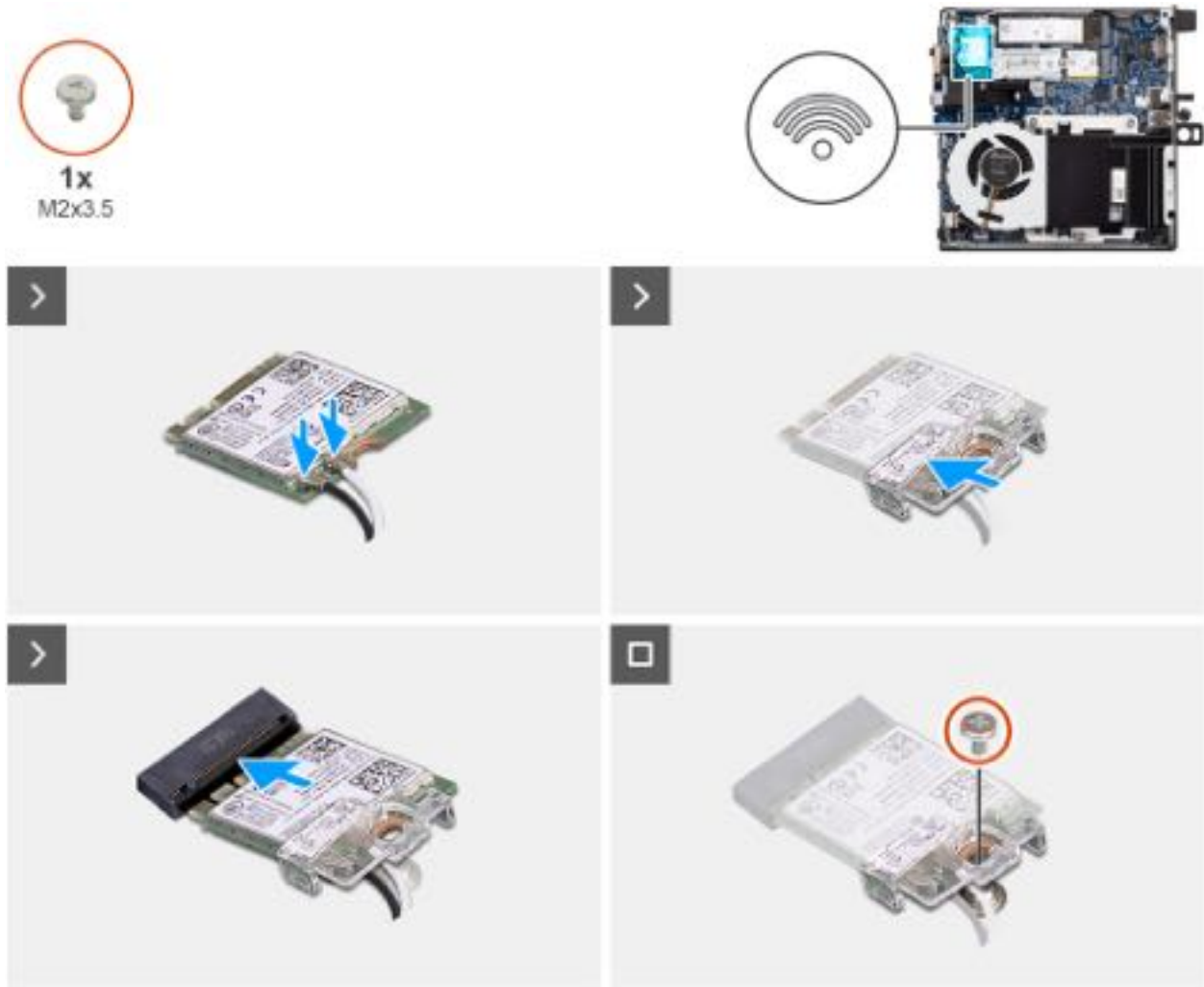
Abbildung 27. Installieren der Wireless-Karte
