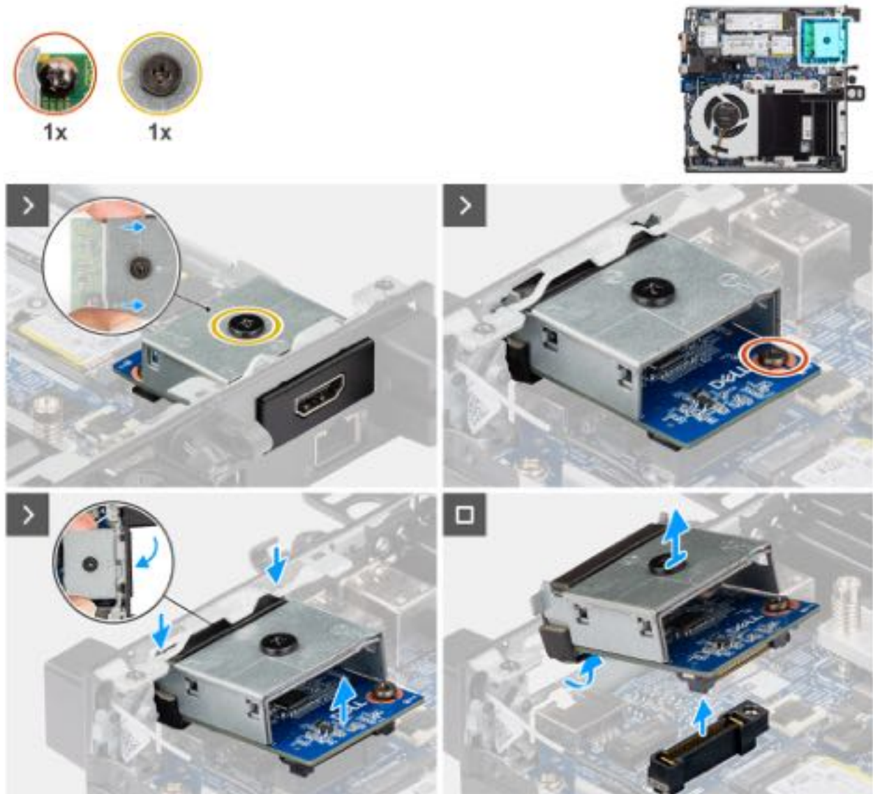
Abbildung 47. Entfernen des HDMI-Anschlussmoduls
