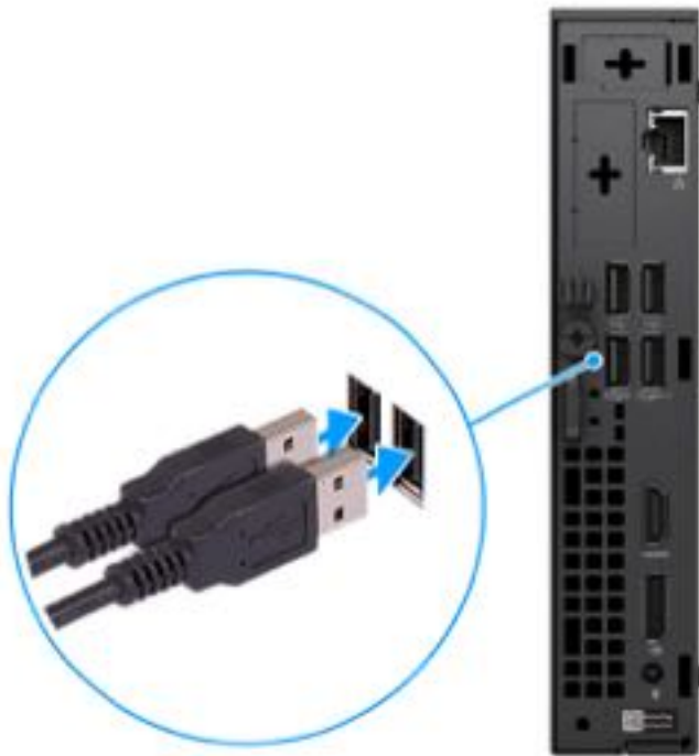
Abbildung 4. Verbinden der Tastatur und der Maus mit dem Dell Pro Micro QCM1250
