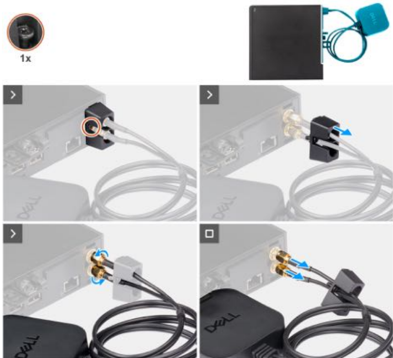
Abbildung 34. Entfernen der externen Puck-Antenne
