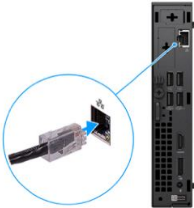
Abbildung 5. Stellen Sie über ein Kabel eine Verbindung zum Netzwerk her.
