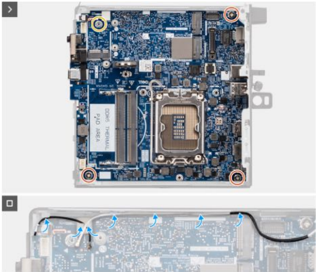
Abbildung 79. Einbauen der Systemplatine
