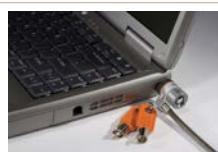
Das Fujitsu Kensington MicroSaver Slim verfügt über den patentierten T-Kupplungs-Sperrmechanismus mit einem Kabel mit gehärtetem Kohlenstoffstahlkern und Stahlgeflechtmantel. Das MicroSaver Slim ist mit Kensington Master Access erhältlich. Mit dieser Sicherheitslösung können Sie eine unbegrenzte Anzahl von Schlossern mit einem einzigen Generalschlüssel verwenden.
